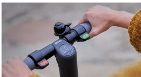
Ein Display zeigt Geschwindigkeit, Fahrmodus und Akkustand an
