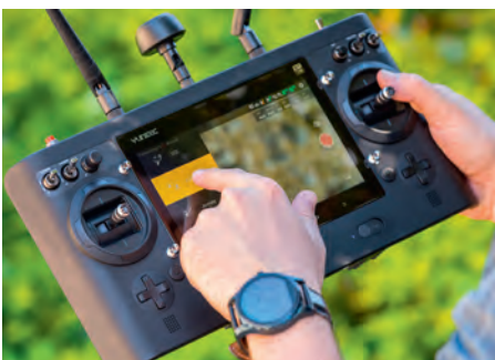
ST16S-Fernsteuerung mit 720p-HD-Display
